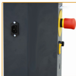
Ingebouwde noodstop en laadpunt
